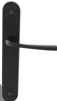
*Infos+* Vis reliure pour porte d'épaisseur 38 à 42 mm. Carré 7 mm. Ressort de rappel sauf perçage cylindre.
