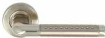
Infos+ Vis relieure d'entraxe 38 mm ou vis filet bois. Poignées avec vis poin-teau pour serrage sur carré de 7 mm. Ressort de rappel.
