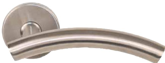
Béquille en inox brossé qualité AISI 304 de forme courbée en arc de cintre en vue de face de 19 mm de diamètre, de longueur 140 mm, avec partie cintrée qui dépasse de 20 mm vers la gauche de chaque côté. Les parties cintrées par rapport à l'axe de la béquille se terminent en embouts droits.
