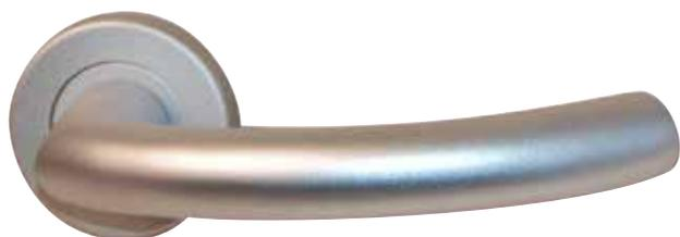
Béquille avec une forme en arc, de 19 mm de diamètre en aluminium finition naturel perlé, de longueur 135 mm, et de saillie 65 mm se terminant en biseau.
