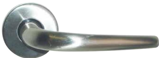
Béquille cintrée en arc et de forme conique en s'affinant vers la fin, en laiton finition nickel mat, de longueur 120 mm et de saillie 60 mm.
